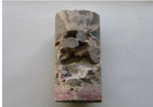
**Gambar 5.** Benda uji beton inti yang tidak layak
