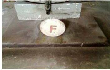
Gambar Silinder Beton Siap untuk Dilakukan Test Kuat Tarik Belah
