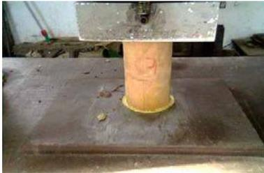
Gambar Silinder Beton Siap untuk Dilakukan Test Kuat Tekan
