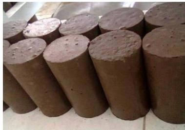
Gambar Beton Geopolimer yang telah mengeras dan siap untuk diCuring
