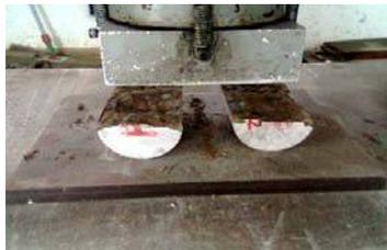
Gambar Silinder Beton Setelah Dilakukan Test Kuat Tarik Belah
