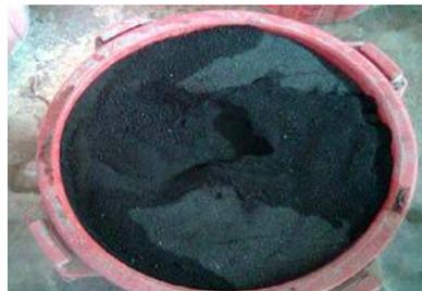
Gambar Agregat halus (pasir)
