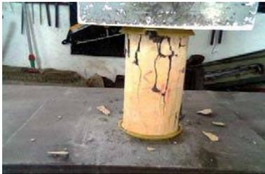
Gambar Silinder Beton Setelah
