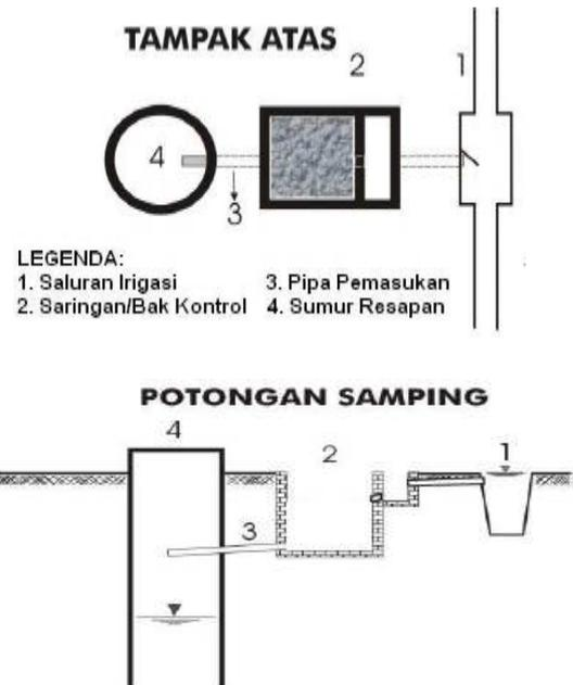
Gambar 2. Sumur Resapan Konvensional
