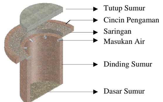
c. Detail Konstruksi
